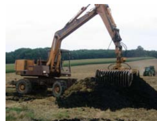
L'optimum pour la reprise des boues déshydratées : la pelle preneuse.
