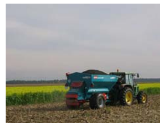
L'optimum pour l'épandage des boues séchées : un distributeur à engrais.
