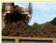
Boues déshydratées chaulées
