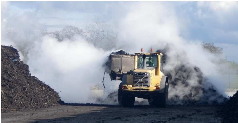
La montée en température hygiénise le compost et évapore une partie de l'eau
